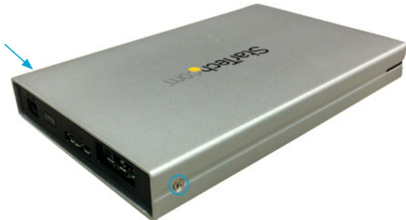
6. eSATA/eSATApまたはUSB 3.0を使用してHDDケースをお使いのコンピュータに接続してインストールを完了します。
