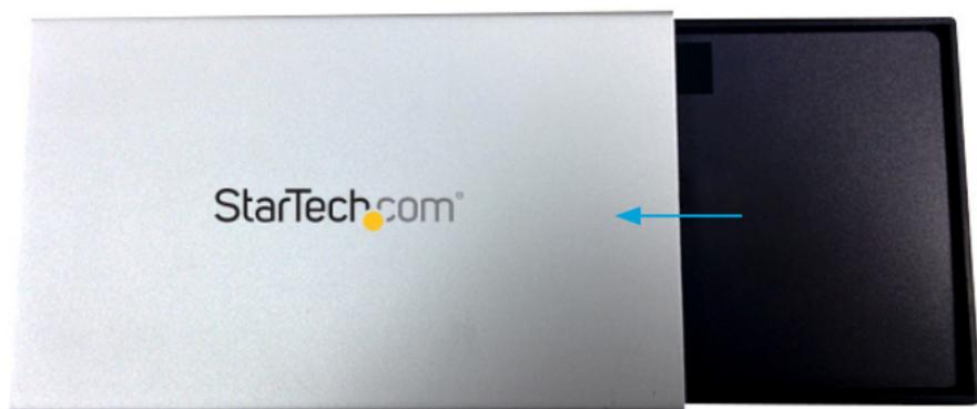
5. ケース側面のHDDトレイ取付用穴にHDD取付用ネジ2本(小さい方の付属ネジ)を通し、付属のプラスドライバでしっかり固定して、HDDトレイをケースに装着します。
