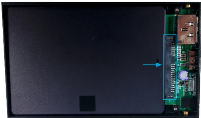
3. ドライブトレイ底部の穴とHDD/SSD底部の取付用穴にHDD取付用ネジ2本(大きい方の付属ネジ)を通し、付属のプラスドライバーでしっかり固定して、2.5インチ SATA HDD/SSDをドライブトレイに装着します。
